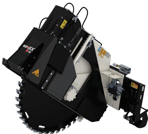
Expressément conçues pour leur adaptation sur les chargeuses compactes, les scies à rocher Simex permettent de traiter différentes surfaces dures, telles que l'enrobé, le béton et la roche et de réaliser des coupes et saignées étroites et à section prédéfinie, des mini/micro tranchées pour les réseaux de fibre optique. La sécurité des personnes et de l'environnement est toujours garantie grâce à la protection totale du disque quelle que soit la profondeur de travail.
